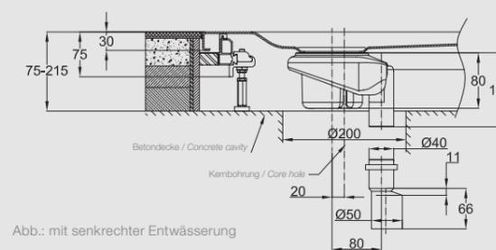
Abb.: mit senkrechter Entwässerung
