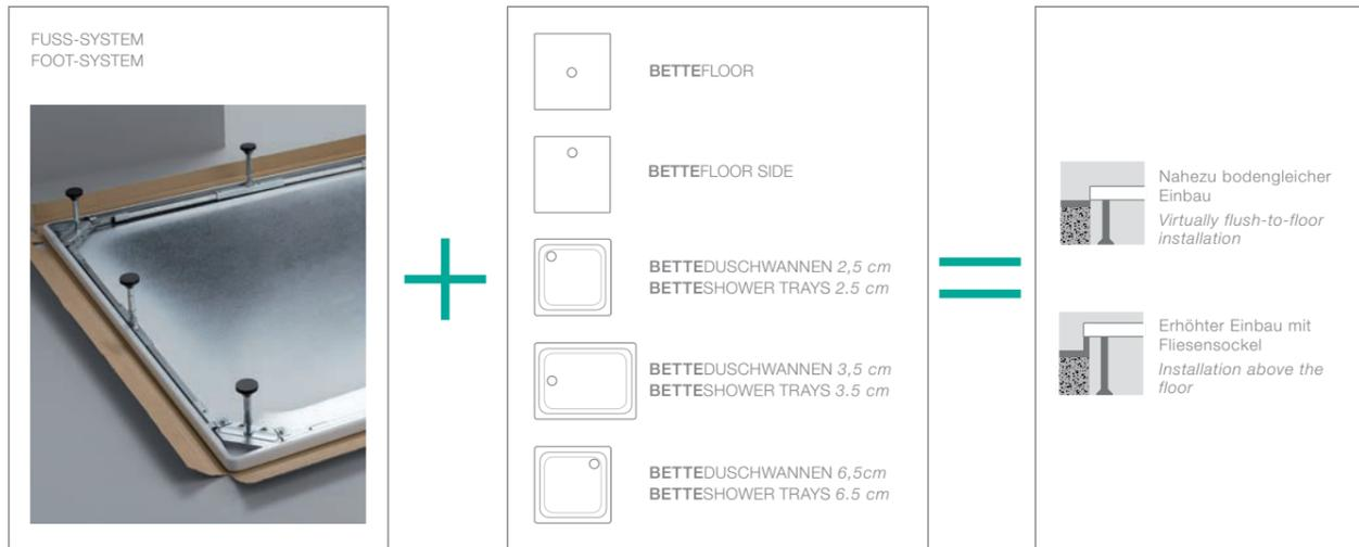
Das **BETTEFUSS-SYSTEM** garantiert den schnellen, sicheren und kostengünstigen Höhenausgleich beim Einbau von Duschwannen und Duschflächen. Hierzu wird ein Rahmen unter dem Wannenrand verspannt, in den die höhenverstellbaren Füße eingeschraubt werden.
