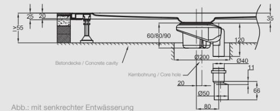
Abb.: mit senkrechter Entwässerung
