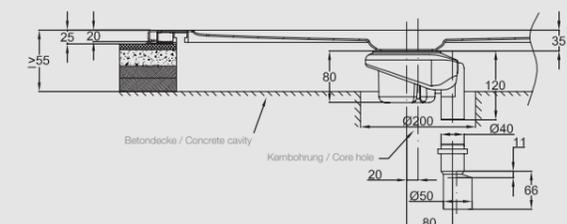
Abb.: mit senkrechter Entwässerung
