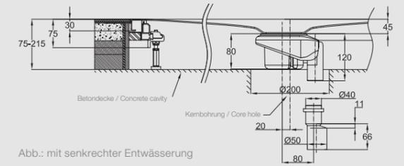
Abb.: mit senkrechter Entwässerung
