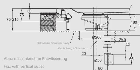
Abb.: mit senkrechter Entwässerung
