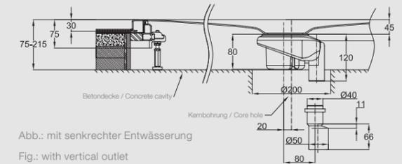
Abb.: mit senkrechter Entwässerung
