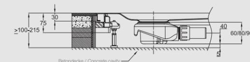
Abb.: mit seitlicher Entwässerung
