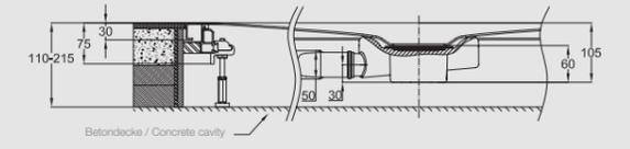
Abb.: mit seitlicher Entwässerung
