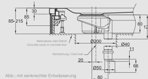
Abb.: mit senkrechter Entwässerung
