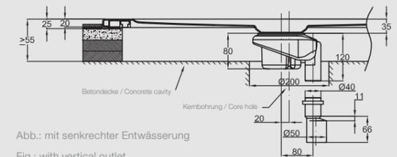
Abb.: mit senkrechter Entwässerung
