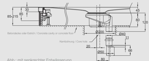
Abb.: mit senkrechter Entwässerung
