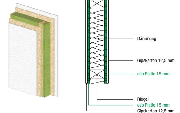
Die aufgezeigten beispielhaften Aufbauten in Wand, Decke und Dach sind exemplarische Darstellung. Sie ersetzen nicht die bauphysikalische Berechnung im Einzelfall unter Berücksichtigung aller örtlichen Gegebenheiten. Die aufgeführten Beispiele stellen Informationen dar ohne Zusicherung von Eigenschaften.
