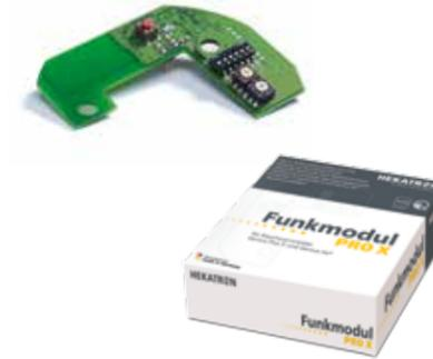
Vernetzung für den Profi. Das Funkmodul Pro X vernetzt alle Genius Plus X-Geräte und überzeugt mit Sammelalarmlinien, Funkstreckenüberwachung und vielem mehr.
