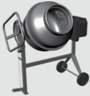
Die NORIT-Gebundene Schüttung kann mit einem Trommelmischer, Fallmischer oder einer Mischpumpe angemischt werden. Beim Anrühren von Hand werden ca. 8 - 9 Liter Wasser pro 15 kg Sack Schüttung zu einer plastischen Konsistenz gemischt.
