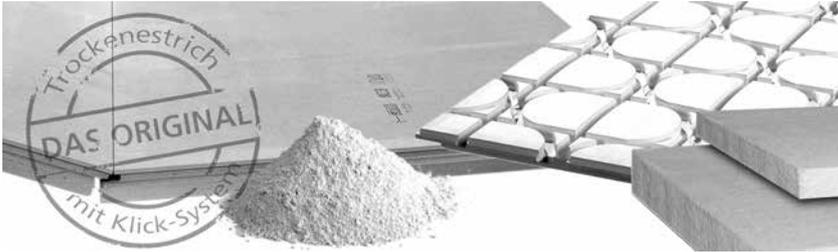
NORIT-Gipsfaserplatten bestehen aus REA-Gips (ein reines Recycling-Produkt) und Zellulosefasern. Diese beiden Rohstoffe werden zu einem homogenen Gemisch verarbeitet und nach Zugabe von Wasser – ohne weitere Bindemittel – zu stabilen Platten geformt, getrocknet und auf die benötigten Formate zugeschnitten.
