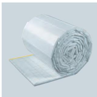
*Uponor Klett Rollplatte – als Rohrträger in gerollter Ausführung mit Wärme- und Extra-Trittschalldämmung nach DIN EN 13163 und DIN 4108-10 aus EPS-Hartschaum mit aufkaschierter Gewebe-Haftfolie zur überlappenden Verlegung, mit einseitig selbstklebendem Folienüberstand zur Abdeckung der Dämmschicht gem DIN 18560.*
