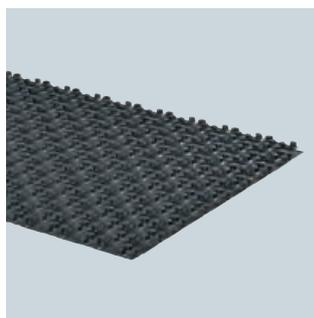
*Uponor Nubos Noppenfolie – zur Verlegung auf bauseitiger Dämmung. Folienelement ohne Hinterschäumung. Vakuumgeformte PS-Tiefziehfolie aus schlagfestem Polystyrol mit integrierten Rohrhaltenoppen zur sicheren Einhaltung der Rohrabstände und zur exakten Höhenfixierung der Uponor Systemrohre.*
