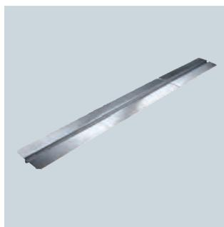
*Uponor Siccus Wärmeleitlamellen – stabile Aluminium-Lamellen mit Omega-Nut für den optimalen Wärmeübergang zum Systemrohr. 2-fach Vorstanzung für einfaches werkzeugloses Kürzen. Lamellengröße 120 x 1180 mm.*
