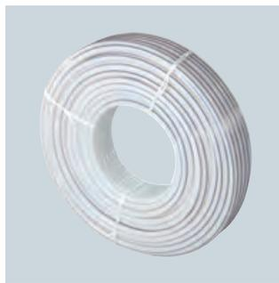
*Uponor Comfort Pipe PLUS – PE-Xa Rohr mit Sauerstoffdiffusionssperre aus EVOH und einer zusätzlichen äußeren Schutzschicht. Farbe weiß mit zwei blauen Streifen. Entspricht der DIN EN ISO 15875 „Kunststoff-Rohrleitungssysteme für Warm- und Kaltwassersysteme, vernetztem Polyethylen“, Sauerstoffdicht nach DIN 4726.*
