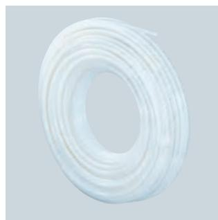
*Uponor Minitic Comfort Pipe 9,9 mm mit Sauerstoffdiffusionssperre aus EVOH, Farbe natur mit einem blauen Streifen. Entspricht der DIN EN ISO 15875 „Kunststoff-Rohrleitungssysteme für Warm- und Kaltwassersysteme, vernetztes Polyethylen“, Sauerstoffdicht nach DIN 4726.*
