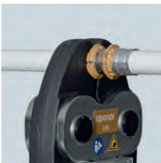
*Uponor S-Press – Farbführung gleicher Nennweiten an Pressbacke und Pressfitting von 14 – 32 mm.*
