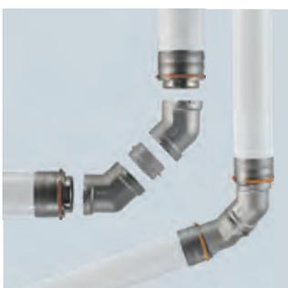
*Flexible Winkel – besonders in Altbauten sind Wände und Decken oft nicht rechtwinklig zueinander. Mit den Distanzadaptern (5 mm) in Verbindung mit zwei 45° Winkeln kann jeder gewünschte Winkel durch Verdrehen der Komponenten realisiert werden.*
