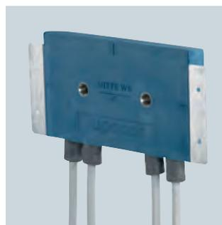
*Die Uponor ISI-Boxen bestehen aus einem wärmegeprägten und kondenswassersicheren Isolierkörper mit vormontierten, anschlussfertigen Trinkwasserkomponenten aus dem bewährten Uponor Verbundrohrsystem.*
