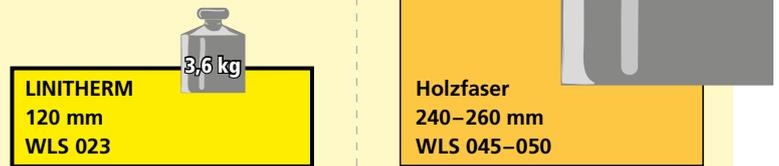
Dämmplatte aus PUR/PIR-Hartschaum wiegt 3,6 kg pro Quadratmeter
