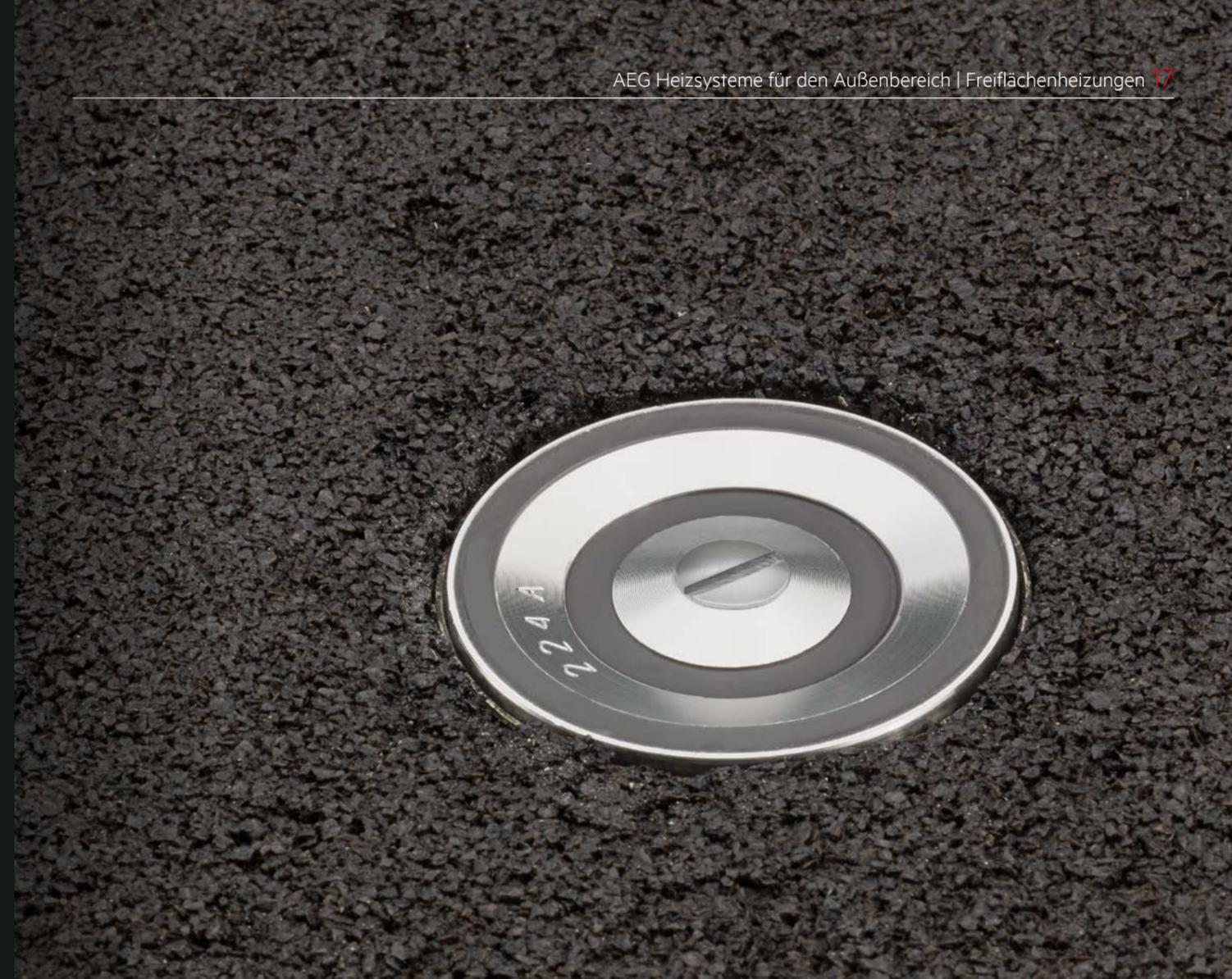
Der **Temperatur- und Feuchtefühler EF 50-25 H** ist ein wichtiges Element jeder Freiflächenheizung: Er wird ebenerdig in Beton oder Asphalt verlegt, wo Niederschläge ihn unmittelbar erreichen. Werden die festgelegten Temperaturwerte unterschritten und es setzt Regen oder Schneefall ein, dann aktiviert sich das Heizsystem automatisch, bevor Schnee- und Eisflächen entstehen können.
