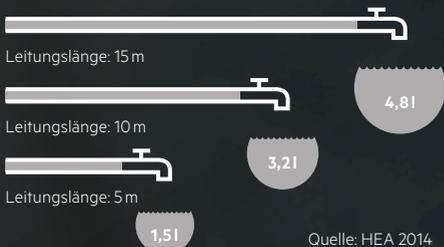
Denn moderne Durchlauferhitzer erwärmen das Wasser bedarfsgerecht am Verbrauchsort und führen es über kurze Leitungswege zum Auslauf – ohne Umwege und unnötige Energieverluste. Weniger als drei Prozent Wärmeenergie gehen dabei verloren. Die elektrische Warmwasserbereitung ist so – vor allem auch im Hinblick auf den angestrebten Strommix – eine umweltfreundliche und zukunftsweisende Technologie.
