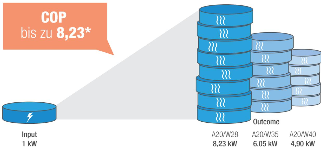
\* Betriebspunkt (A20/W28) Dieser Wert wurde am ILK Dresden für Abluft mit 20 °C und 50 % relative Luftfeuchtigkeit gemessen. Da diese Werte in der Abluft regelmäßig höher liegen können, sind durchaus noch größere COP-Werte möglich.
