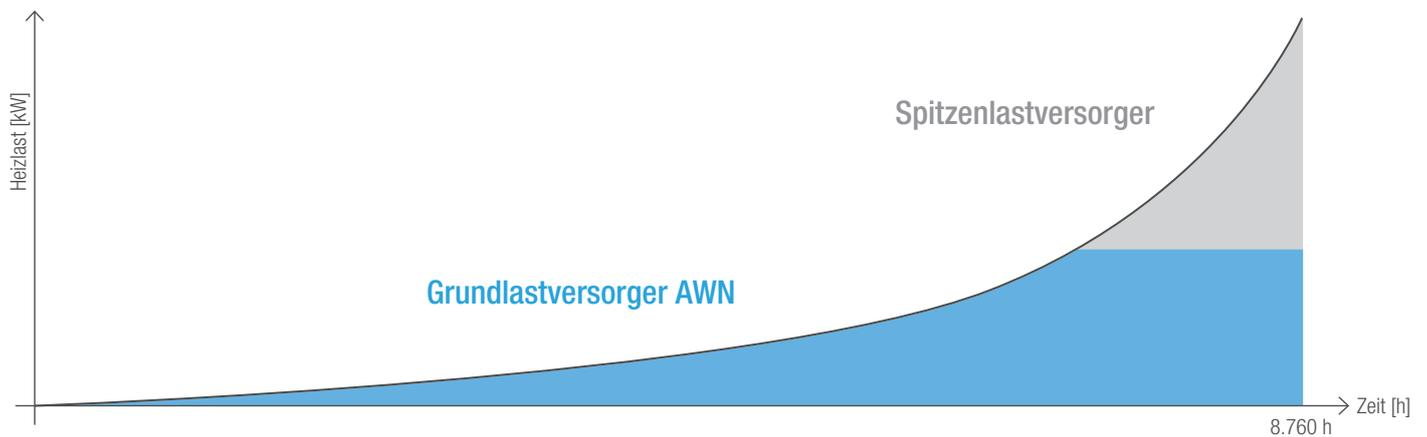
**Die Wärmeleistung einer AWN reicht zu einem Großteil der Stunden aus, um die Heizlast des Gebäudes zu decken.** Bei kalten Außentemperaturen und zu Zeiten hohen Warmwasserbedarfs, bedarf es einer Unterstützung durch einen weiteren Wärmeerzeuger.
