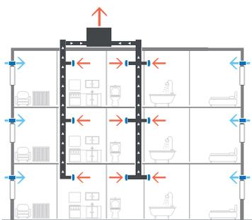
MFH (zentrales Lüftungsgerät)
