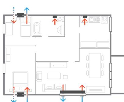
MFH / EFH (dezentrale Lüftungsgeräte)
