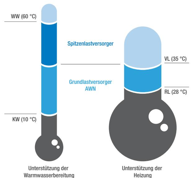
Grundsätzlich muss die individuelle hydraulische Einbindung den Vorrang der zurückgewonnen Abwärme gewährleisten. Hohe Betriebszeiten werden insbesondere durch Wärmesenken mit geringen Temperaturen ermöglicht
