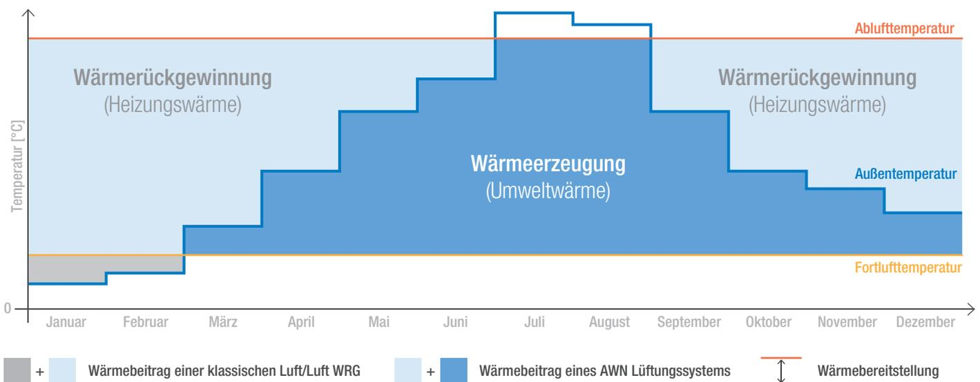
Die Abluft bietet nicht nur an frostigen Wintertagen eine attraktive Wärmequelle. In der Übergangszeit zwischen Winter und heizungsfreier Zeit herrschen kleinere Differenzen zwischen Außen- und Raumtemperatur. Die anliegende Heizlast des Gebäudes kann dann unter Umständen sogar vollständig durch die AWN gedeckt werden.
