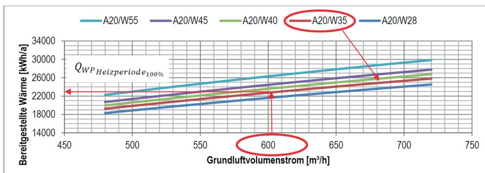
Für die Optimierung des EnEV Nachweises (Anlagenaufwandszahl), haben niedrige Vorlauftemperaturen höheren Einfluss als die korrespondierenden, gegenläufigen Deckungsbeiträge. Die Diagramme finden Sie in Anhang 2.
