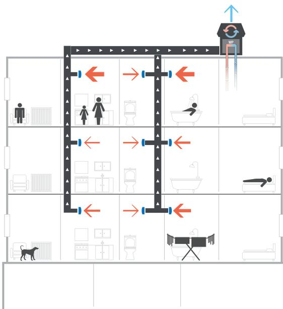
Je nach Nutzung einer Wohneinheit herrscht immer ein anderer Lüftungsbedarf. So konzentriert sich der Bedarf immer dort, wo Feuchtigkeit produziert wird, beispielsweise während des Duschens oder Kochens (Grafik links). In diesen Fällen fördert das bedarfsgeführte Abluftsystem mehr Luft aus der Wohnung. Zu Zeiten, in denen die Bewohner nicht zu Hause sind, wird die Abluftmenge auf das nötige Minimum reduziert.
