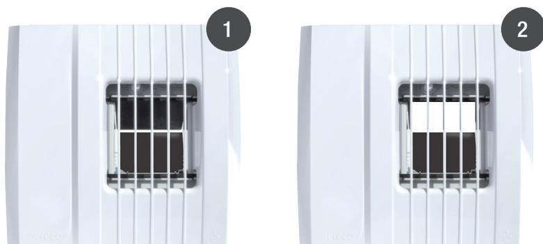
Der mechanische Aereco Feuchtesensor ändert den Öffnungsquerschnitt des Abluetelements in Abhängigkeit zu der relativen Raumlufffeuchte.
