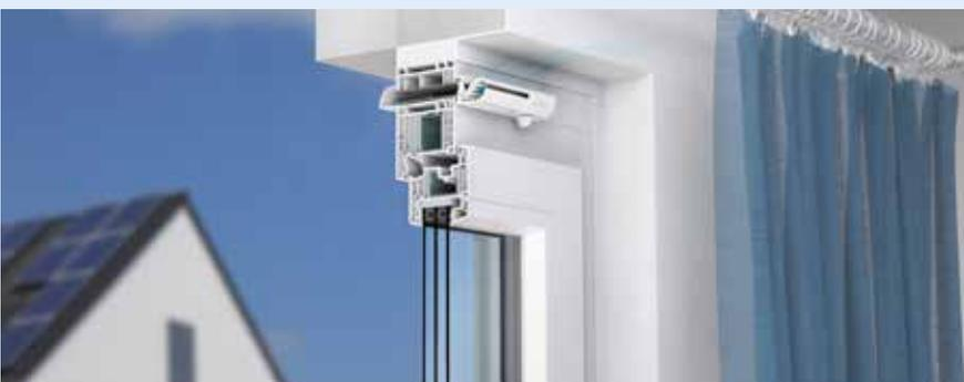
Die Nachströmung der frischen Luft erfolgt über die feuchtegeführten Außenbauteil-Luftdurchlässe in den Wohn- und Schlafräumen. Hierfür können zum Beispiel ALD für den Fenstereinbau (Abbildung links) eingesetzt werden. Dank der integrierten Feuchterfassung strömt die Frischluft vor allem in die Räume mit einem höheren Belüftungsbedarf.
