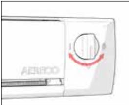
Ein manueller Verschlusshebel ermöglicht es, den ALD zu schließen oder zu öffnen: Bewegen Sie dafür den Hebel nach rechts (Pos. 0: geschlossen) bzw. nach links (Pos. 1: geöffnet) bis er einrastet: Beim Verschluss ist die hygrometrische Regelung nicht aktiv, es besteht aber immer eine Grundlüftung (ca. 2,4 m<sup>3</sup>/h bei 8 Pa).
