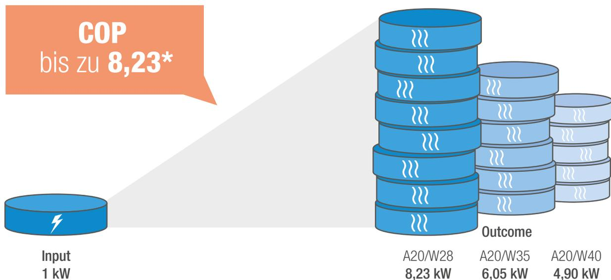
\* Die Werte wurden am ILK Dresden für Abluft mit 20 °C und 50 % relativer Luftfeuchtigkeit gemessen. Da der Wärmegehalt in der Abluft regelmäßig auch höher liegen kann, sind auch noch größere COP-Werte möglich.
