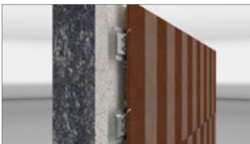
Lagesicherung der Platten an den K20-Omegaprofilen
