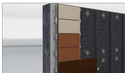
KeraTwin®-Platten in vertikalen Reihen montieren
