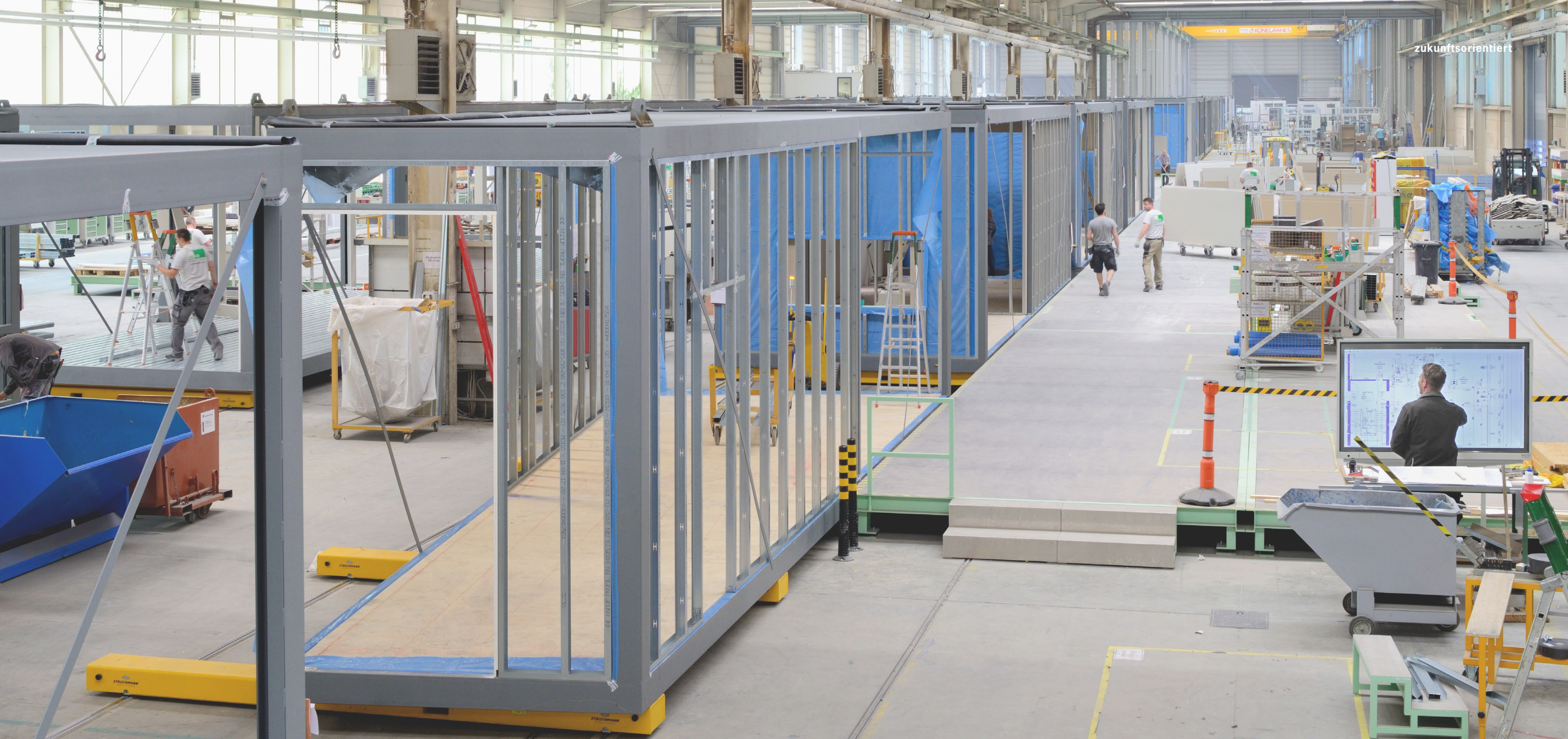
Die serielle Fertigung in der ALHO Raumfabrik
