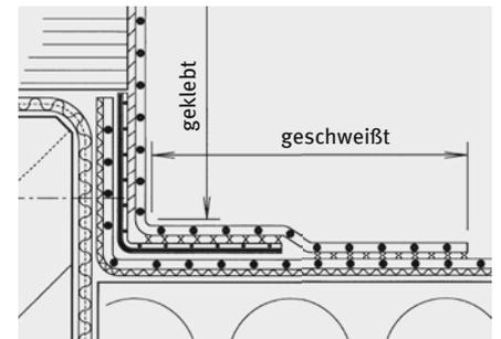
VSKA-Anschlussbahnen werden mit einem beidseitigen oder einseitigen, unbeschichteten Schweißrand hergestellt. Auf diese Weise ist die materialhomogene Verschweißung der VSKA-Anschlussbahnen mit der EVALASTIC®-Abdichtung sichergestellt.
