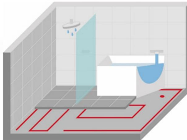
Durch die innovativen Flächensensoren von Optidry lässt sich ein Schaden auf die betroffene Fläche eingrenzen. Somit kann die genaue Stelle schnell und einfach zugänglich gemacht und abgedichtet werden. Nur so können Folgeschäden minimiert und vor allem frühzeitig erkannt werden.
