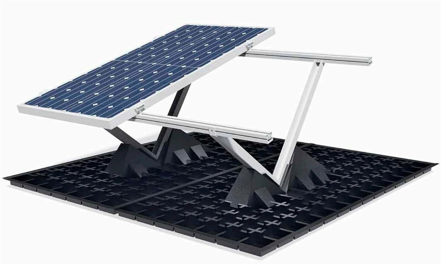
Die BauderSOLAR UK GD ist die Montagelösung zur Errichtung von Photovoltaikanlagen auf Gründächern. Das System nutzt die Substratschicht der Begrünung als Ballast für die Unterkonstruktion.
