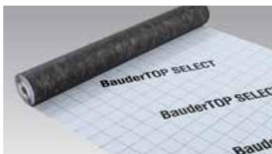
Dampfbremse mit einstellbarem  $sd$ -Wert für die Dachsanierung von außen.  $sd$ -Wert  $\leq 0,1$  m (Folie abgezogen);  $sd$ -Wert  $\geq 4,6$  m (Folie belassen)
