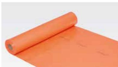
PE-Folie nach DIN EN 13984 als luftdichte Schicht bei direkter Verlegung der BauderPIR Wärmedämmelemente auf den Sparren.  $sd > 220$  m
