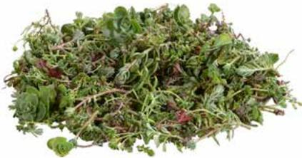
Mischung aus mindestens 5 verschiedenen Sedumarten/ -sorten für die Trockenansaat von extensiven Dachbegrünungen. Die Sedumsprossen sollten nach Möglichkeit am Liefertag ausgebracht werden. (Nur in ausgebreitem Zustand an einem kühlen und trockenen Ort für max. 3 Tage lagerbar). Verbrauch ca. 50 - 80 g/m<sup>2</sup>.
