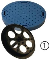
Aus Polypropylen. Die innere Seite hat eine Wabenstruktur, die äußere Oberfläche ist perforiert. Zur Befestigung von leichten Bauteilen, wie Rollladenführungsschienen, Hausnummern, Temperaturfühlern, leichten Schildern.
