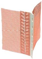
Gewebeeckwinkel für Kratzputz\*, für Gesamtputzschicht 15 mm oder 12 mm, weitere Varianten auf Anfrage erhältlich. Gewebebrette 125 mm, Gewebe 6 x 6 mm.
