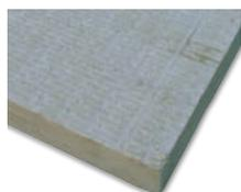
Mineralwolle-Fassadendämmplatte nach DIN EN 13162, DIN 4108-10 WAP, einseitig beschichtet, Euroklasse A1 nach DIN EN 13501-1, nichtbrennbar. Bemessungswert der Wärmeleitfähigkeit 0,035 W/(m·K). Verbesserung des Schalldämm-Maßes. Verdübelung: Dübelteller Ø 60 mm oberflächenbündig, ab 12 cm Dämmstoffdicke versenkt möglich (dazu technisches Merkblatt beachten).
