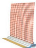
Für exakten, schlagregendichten Putzanschluss mit PUR-Band für Kratzputz.\* Zweiteiliges Profil mit Schattenfuge. Gewebebreite 125 mm. Kratzputzdicke 10–15 mm.
