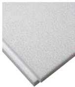
Polystyrol-Deckendämmplatte nach DIN EN 13163, Euroklasse E nach DIN EN 13501-1, mit Struktur in der Oberfläche, Stufenfalz. Bemessungswert der Wärmeleitfähigkeit 0,035 W/(m·K). Farbe: weiß. Format: 50 x 50 cm (Nutzmaß: 48,5 x 48,5 cm), Dämmstoffdicken von 5–12 cm.
