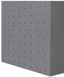
Diffusionsoffene Polystyrol-Fassadendämmplatte nach DIN EN 13163, abgestimmt auf Ziegelmauerwerk, mit hervorragenden Wärmedämmeigenschaften, speziell entwickelt für das WDV-System SuperDämmfassade (open), schwerentflammbar, B1 nach DIN 4102-1 im WDV-System mit zusätzlichen Brandschutzmaßnahmen. Bemessungswert der Wärmeleitfähigkeit 0,032 W/(m·K). Farbe: grau, Format: 50 x 100 cm, Dämmstoffdicken von 6–20 cm.
