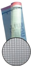
Feines, schiebefestes, alkalibeständiges Textilglasgewebe zum Einbetten in Kleber- und Spachtelmassen, systemgeprüft, Reißfestigkeit  $\geq 1,8$  kN/5 cm.
