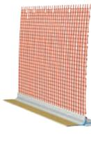
Selbstklebendes Kunststoffprofil mit Dichtband und Gewebe, zur Herstellung eines schlagregendichten Anschlusses des WDVS an den Fensterstock mit Schattenfuge. Einsatzbereich: siehe Auswahlkriterien. Geeignet für Armierungsschichtdicken 3–6 mm.
