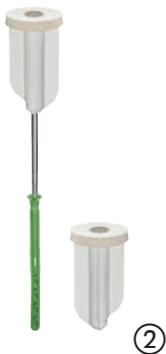
Konstruktives Befestigungssystem, bestehend aus einer Montagebuchse aus glasfaserverstärktem Kunststoff inkl. hochwertiger EPDM-Dichtscheibe und einem Fassadendübel (Ø 8 mm). Für die nachträgliche Montage von leichten bis mittelschweren Anbauteilen an WDVS-Fassaden aus EPS- und Mineralwolle-Dämmstoffen.
