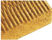
Mineralwolle-Fassadendämmplatte nach DIN EN 13162, DIN 4108-10 WAP, Euroklasse A1 nach DIN EN 13501-1, nichtbrennbar. Bemessungswert der Wärmeleitfähigkeit 0,035 W/(m·K). Format: 80 x 62,5 cm.
