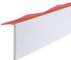
Laibungssystem, bestehend aus einem Laibungselement sowie einem passenden Anschlussprofil. Durch die 5 mm dicke Putzschicht an der Oberfläche kann die Fläche direkt beschichtet werden. Das Laibungselement besteht aus EPS, Bemessungswert der Wärmeleitfähigkeit  $0,035 \text{ W/(m-K)}$ , mit eingeklebtem Kombiwinkel und Gewebe.
