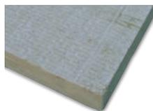
Mineralwolle-Fassadendämmplatte nach DIN EN 13162, DIN 4108-10 WAP, beidseitig beschichtet (Produktseite mit beschichtungsfreien Streifen = Klebeseite). Euroklasse A1 nach DIN EN 13501-1, nichtbrennbar. Bemessungswert der Wärmeleitfähigkeit 0,035 W/(m·K). Verbesserung des Schalldämm-Maßes. Verdübelung Dämmstoffdicke ≤ 200 mm mit Dübelteller Ø 60 mm oberflächenbündig, ab 10 cm Dämmstoffdicke versenkt möglich (dazu technisches Merkblatt beachten).
