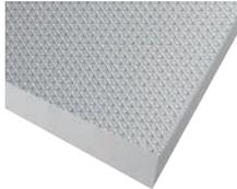
Polystyrol-Dämmplatte nach DIN EN 13163, zugelassen für Anwendung bis 3 m im erdberührten Bereich, schwerentflammbar, B1 nach DIN 4102-1 im WDV-System mit zusätzlichen Brandschutzmaßnahmen. Bemessungswert der Wärmeleitfähigkeit 0,035 W/(m·K). Format: 50 x 100 cm, Dämmstoffdicken von 5–30 cm.
