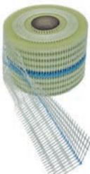
PanzerEckwinkel mit alkalibeständigem Textilglasgewebe (ca. 280 g/m<sup>2</sup> und Reißfestigkeit > 2,5 kN/5 cm) für die Anwendung in Außen- und Innenecken. Speziell für den Einsatz der Inneneckausbildung bei schwerentflammaren EPS-Fassaden.
