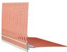
Kunststoffwinkel mit Tropfkante, für horizontale Putzanschlüsse, überputzbar. Geeignet für Armierungsschichtdicken 3–10 mm.
