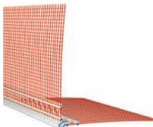
PVC-Eckwinkel mit alkalibeständigem Textilglasgewebe, vorstehender Abzugskante mit codierter (rauer) überputzbarer Oberfläche, inkl. Steckverbinder zur Verbindung der Eckwinkel (Beutel à 25 Stück). Geeignet für Armierungsschichtdicken 3 – 6 mm.
