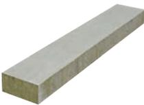
Mineralwolle-Lamelle nach DIN EN 13162, DIN 4108-10 WAP, beidseitig beschichtet, Euroklasse A1 nach DIN EN 13501-1, nichtbrennbar. Bemessungswert der Wärmeleitfähigkeit 0,041 W/(m·K). Zugfestigkeit mind. 80 kN/m<sup>2</sup>. Verdübelung erfolgt mit zusätzlichem DübelTeller SBL 140. Format: 120 x 20 cm, Dämmstoffdicken von 4–30 cm.
