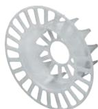
Speziell abgestimmter DübelTeller für die vertiefte Montage in Mineralwolle- und ResoTherm-Dämmplatten (ab Dämmstoffdicke 80 mm) in Kombination mit SchraubDübel S (STR).
