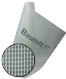
Schiebefestes, alkalibeständiges, verstärktes Textilglasgewebe als zusätzliches Armierungsgewebe unter der normalen Armierung, bei stoßgefährdeten Flächen (Sockelbereich etc.), Reißfestigkeit  $\geq 3,4$  kN/5 cm. Gewicht: ca. 300 g/m<sup>2</sup>.
