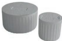
Formgeschäumter Zylinder aus EPS mit wellenförmiger Mantelfläche. Zur Befestigung von Rohrschellen, Kleiderbügelträgern, Starenkästen, Anschlag für Fensterläden, leichten Beleuchtungskörpern im WDV-System. Durchmesser: 70 und 125 mm.
