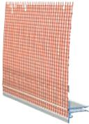
Aufsteckprofil variabel aus Kunststoff mit Gewebe, als entkoppelter Abschluss bei Sonnenschutzanlagen. Für horizontalen und vertikalen Einbau geeignet. Einbindemaß ≤ 2 cm. Gewebebreite: 125 mm. Geeignet für Armierungsschichtdicken 3 – 10 mm.
