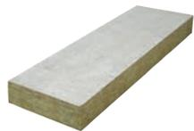
Mineralwolle-Deckendämmplatte nach DIN EN 13162, zur unterseitigen Dämmung von Keller-, Garagen- und Hallendecken, beidseitig beschichtet (geriffelte Produktseite mit beschichtungsfreien Streifen = Klebeseite). Euroklasse A1 nach DIN EN 13501-1, nichtbrennbar. Nach DIN 4108-10 DI, Bemessungswert der Wärmeleitfähigkeit 0,035 W/(m·K). Verbesserung des Schalldämm-Maßes. Format: 120 x 40 cm, Dämmstoffdicken von 6–16 cm.
