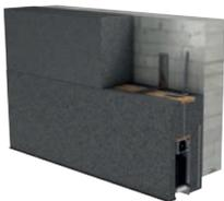
In der Dämmebene verlegter Jalousiekasten mit thermischer Trennung der Anschlüsse an das Mauerwerk. Befestigung durch Kleberauftrag und Montagewinkel. Inkl. Kabeldurchführung. Verkleidung der Innenseiten des Kastens mit Premiumplatten. Der Jalousiekasten wird individuell nach den Angaben im Aufmaßblatt gefertigt. Die Montage der Jalousie erfolgt auf der integrierten Trägerplatte. Lieferung als Variante EPS oder Mineralwolle.
