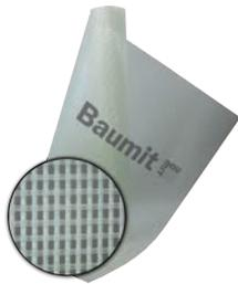
Schiebefestes, alkalibeständiges, verstärktes Textilglasgewebe als zusätzliches Armierungsgewebe unter der normalen Armierung, bei stoßgefährdeten Flächen (Sockelbereich etc.), Reißfestigkeit  $\geq 3,4 \text{ kN/5 cm}$ . Gewicht: ca.  $300 \text{ g/m}^2$ .
