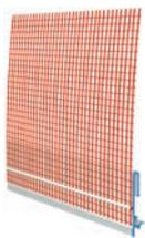
PVC-Aufsteckprofil mit Gewebe und Tropfkante zum universellen Einsatz bei Sockelschienen mit Trogform, inkl. Steckverbinder zur Verbindung der Aufsteckprofile (Beutel à 25 Stück). Zur Minimierung der Rissgefahr im Stoßbereich des Sockels. Geeignet für Armierungsschichtdicken 3-6 mm.
