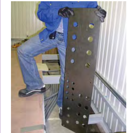
Lochblechplatte für Kabelverschraubungen
