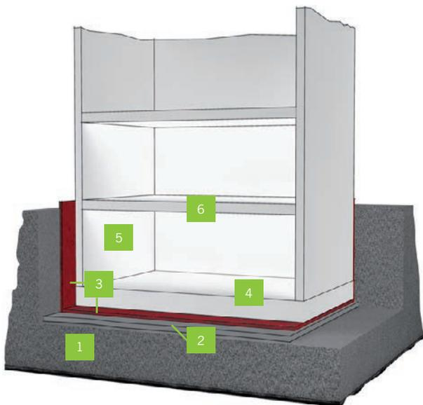
Vollflächige Entkopplung eines Gebäudefundamentes mit **Regupol®/Regufoam®** Schwingungsdämmmaterial: 1 Natürlicher Untergrund • 2 Impedanzplatte • 3 **Regupol®/Regufoam®** Schwingungsisolierung • 4 Fundamentplatte • 5 Kellerwand • 6 Geschossdecke
