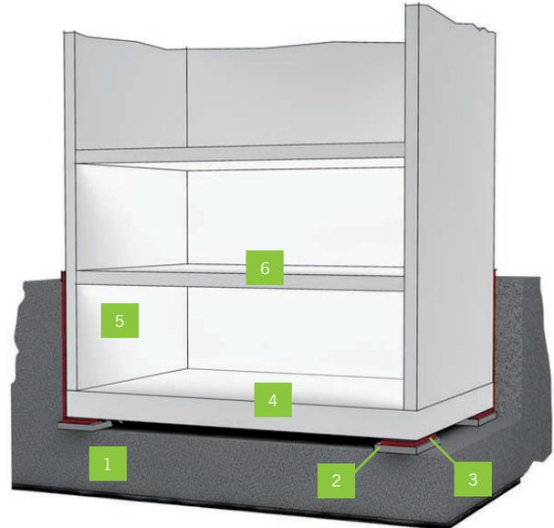
Punktuelle Entkopplung eines Gebäudefundamentes mit **Regupol®/Regufoam®**
