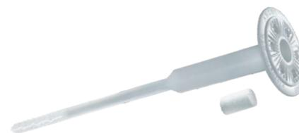
Vormontierter Dämmstoff-Schraubdübel Ø 8 mm Universalschraubdübel, für die vertiefte und oberflächenbündige Montage in Beton und Mauerwerk. Teller Ø 60 mm.
