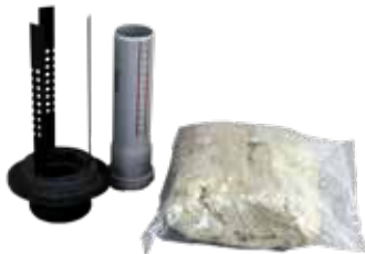
Brandschutz-Set Für den Einbau in Decken mit einer Feuerwiderstandsklasse von F30 bis F120 mit einer Deckenstärke von 150 mm bis 250 mm.
