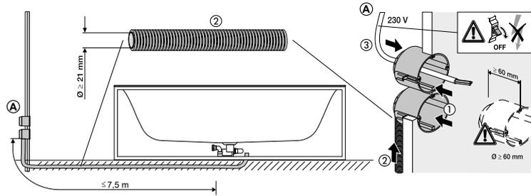
Ab- und Überlaufgarnitur ohne sichtbaren Überlauf. Die Überlauffunktion wird durch einen in die Ablaufgarnitur integrierten Drucksensor sichergestellt, der die Wassersäule in der Badewanne erfasst. Im Lieferumfang der Ablaufgarnitur befindet sich eine Steuerbox, ein 12 V Netzteil, eine Notbatterie und zwei 8 m lange Steuerkabel. Die Steuerbox, inkl. Notbatterie sowie das Netzteil müssen mit Hilfe des 8 m langen Kabel außerhalb der Wanne in zwei zugänglichen Unterputzdosen integriert werden.
