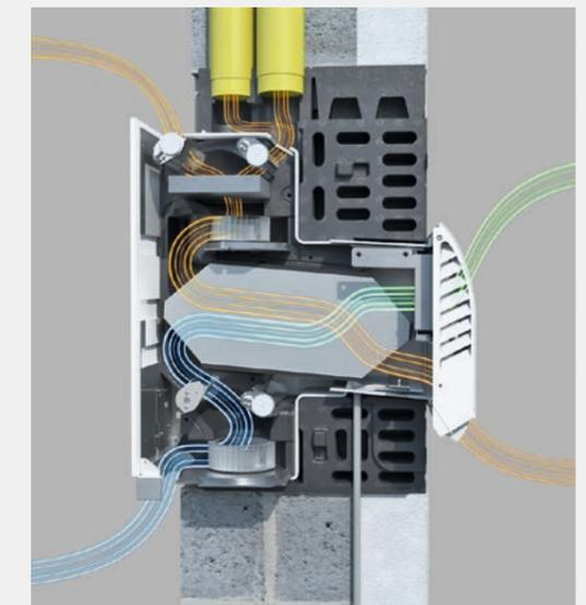
Querschnitt freeAir 100 mit Gegenstrom-Wärmetauscher
