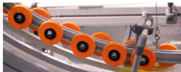
Rollen in einer Förderstation
