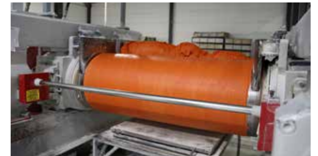
Mischwalzwerk beim Mischen der Rezeptur, nach dem Mastizieren
