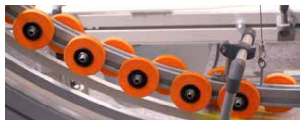
Rollen in einer Förderstation
