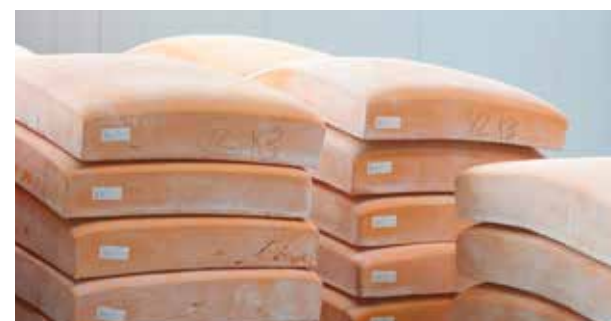
Fertig gebackene Blockware nach dem Ziehen und Entlüften
