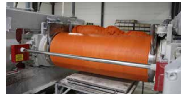
Mischwalzwerk beim Mischen der Rezeptur, nach dem Mastizieren
