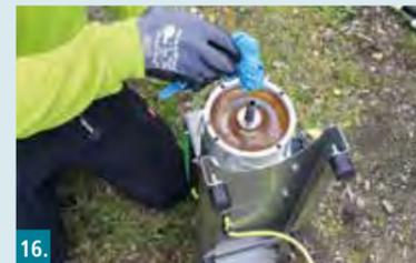
16. Membran reinigen.
