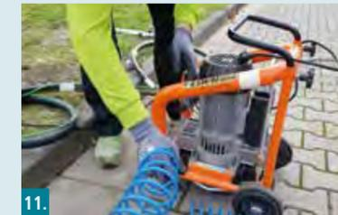
11. Luftschlauch vom Kompressor entfernen.
