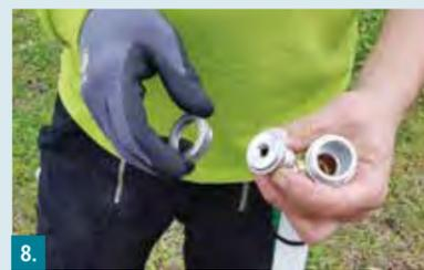
8. Düse mit 5 mm Durchmesser am Spritzkopf anbringen.
