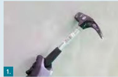
1. Mit der Klopfprüfung können Hohlstellen ausfindig gemacht werden.
