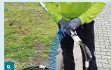
9. Luftschlauch demontieren.
