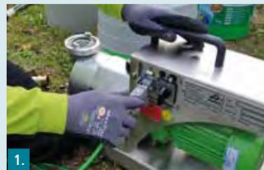
1. Fernbedienung einstecken und Sicherheitsbügel schließen.
