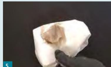
5. Bitumenhaltige Abdichtungen lassen sich auflösen. Bei entsprechender Tragfähigkeit kann die Altabdichtung überarbeitet werden.
