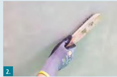
2. Die Wischprüfung mit einer Drahtbürste zeigt, wie stark Oberflächen absanden.
