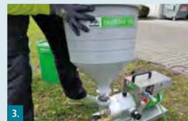
3. Materialbehälter einstecken und Sicherheitsbügel schließen.
