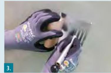
3. Mit der Gitteritzprüfung kann die Oberflächenfestigkeit (besonders von Putzen oder Spachtelschichten) beurteilt werden.
