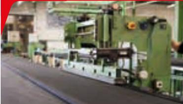
Hot-Bonding ist ein Verfahren, bei dem EPDM-Bahnen durch Vulkanisation miteinander zu großflächigen Planen homogen verbunden werden. Hoher Druck, Zeit und exakt eingestellte Temperaturen sorgen dafür, dass eine 100 % dichte, homogene Verbindung entsteht.
