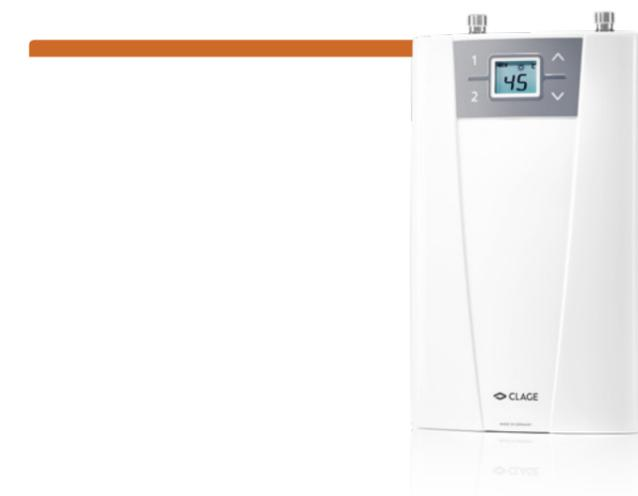
Mit seiner elektronischen Regelung sichert der CEX-U eine energieeffiziente Warmwasserversorgung. Das Wasser wird direkt während des Durchströmens auf die voreingestellte Temperatur erwärmt. Die Temperaturwahl erfolgt per Tastendruck über das LCD-Bedienfeld mit zwei Festwerttasten, die werkseitig mit 35 °C und 48 °C programmiert sind.
