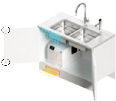
Falls der Sockel nicht min. 4 cm zurückgesetzt ist, muss ein zusätzliches Gitter für Abluft in die Sockelleiste eingesetzt werden
