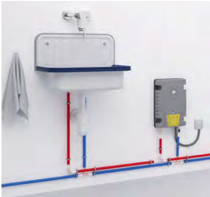
Aufputz-Installation im Hauswirtschaftsraum
