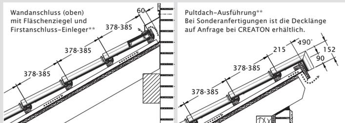
Wandanschluss (oben) mit Fläschenziegel und Firstanschluss-Einleger\*\*
