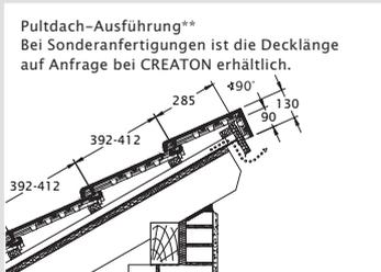
Pultdach-Ausführung\*\* Bei Sonderanfertigungen ist die Decklänge auf Anfrage bei CREATON erhältlich.
