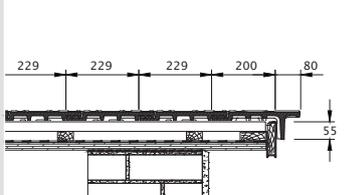
\* Laut dem Regelwerk des ZVDH soll bei Ortgangziegeln der Abstand zwischen Innenkante Ortganglappen und Außenkante Giebelwand bzw. Außenkante Bekleidung mindestens 1 cm betragen.
