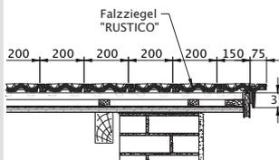
\* Laut dem Regelwerk des ZVDH soll bei Ortgangziegeln der Abstand zwischen Innenkante Ortganglappen und Außenkante Giebelwand bzw. Außenkante Bekleidung mindestens 1 cm betragen.
