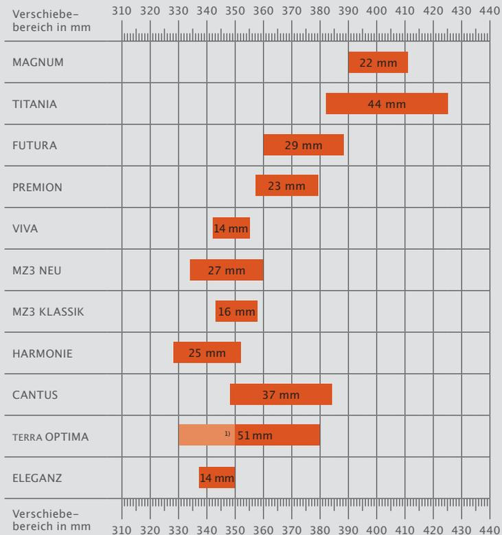
1) Ortgang muss bei einer Decklänge von 330 bis 350 mm ausgeklinkt werden.
