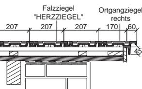
\* Laut dem Regelwerk des ZVDH soll bei Ortgangziegeln der Abstand zwischen Innenkante Ortganglappen und Außenkante Giebelwand bzw. Außenkante Bekleidung mindestens 1 cm betragen.
