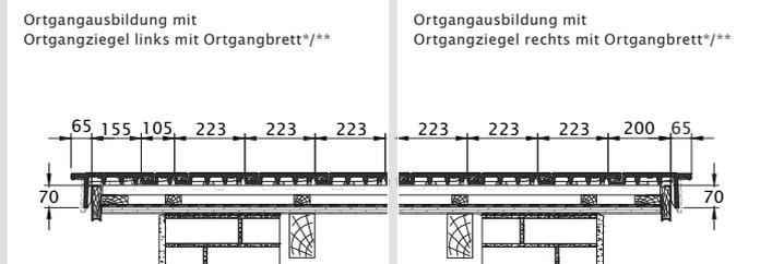
\* Laut dem Regelwerk des ZVDH soll bei Ortgangziegeln der Abstand zwischen Innenkante Ortgangslappen und Außenkante Giebelwand bzw. Außenkante Bekleidung mindestens 1 cm betragen.
