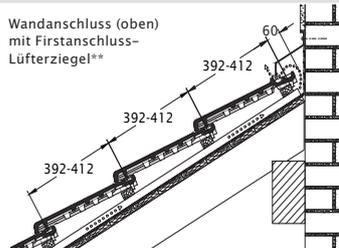
Wandanschluss (oben) mit Firstanschluss-Lüfterziegel\*\*
