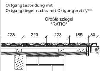
\* Laut dem Regelwerk des ZVDH soll bei Ortgangziegeln der Abstand zwischen Innenkante Ortganglappen und Außenkante Giebelwand bzw. Außenkante Bekleidung mindestens 1 cm betragen.
