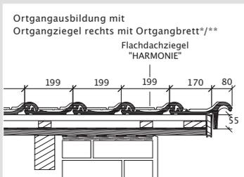
\* Laut dem Regelwerk des ZVDH soll bei Ortgangziegeln der Abstand zwischen Innenkante Ortganglappen und Außenkante Giebelwand bzw. Außenkante Bekleidung mindestens 1 cm betragen.
