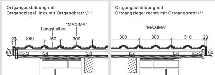
\* Laut dem Regelwerk des ZVDH soll bei Ortgangziegeln der Abstand zwischen Innenkante Ortgang-lappen und Außenkante Giebelwand bzw. Außenkante Bekleidung mindestens 1 cm betragen.
