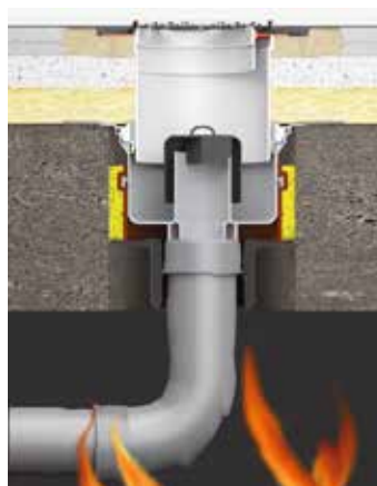
1. Feuer erwärmt den im Brandfall aufschäumenden Baustoff (Dämmstoffbildner)
