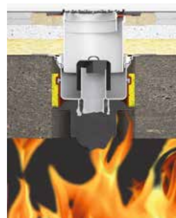
2. Deckendurchführung wird verschlossen
