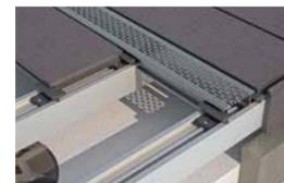
Mit den Lüftungsprofilen wird die erforderliche Hinterlüftung bei Terrassen gewährleistet und die permanente Feuchtigkeit auf den Terrassenprofilen reduziert.
