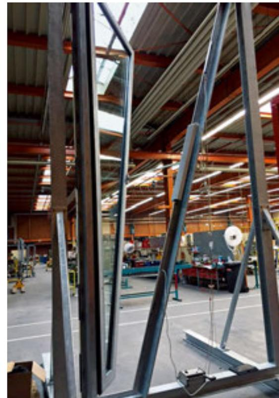
**AN DIESEM MUSTER** in Originalgröße wurde die endgültige Antriebs- und Verriegelungslösung der Öffnungsflügel ausgiebig getestet.
