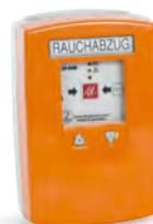
**RWA Kompaktzentrale** mit integriertem Rauchabzugs- und Lüftungstaster: nimmt Signale der Brandmelder auf, wertet Messergebnisse aus, steuert Fensterantriebe und die Lüftungsfunktion
