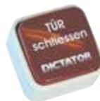
**Hinweis:** Nach nationalen und europäischen Regelungen muss der Haftmagnet einer Feststallanlage an einem Feuer- oder Rauchschutzabschluss über einen genau definierten Handtaster verfügen, der nicht durch den geöffneten Abschluss verdeckt sein darf und Vorgaben zur Montageposition hat. In einem Haftmagneten integrierte Taster erfüllen im Regelfall diese Anforderungen nicht!
