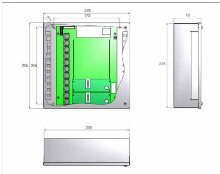
Die Zugentlastung für die ein- und ausgehenden Kabel wird durch Befestigung der Kabel mit Hilfe von Kabelbindern an den beiden Kabelauflegewinkeln erreicht. Die Kabeleinführungen werden staubsicher durch Schaumstoff abgedichtet.
