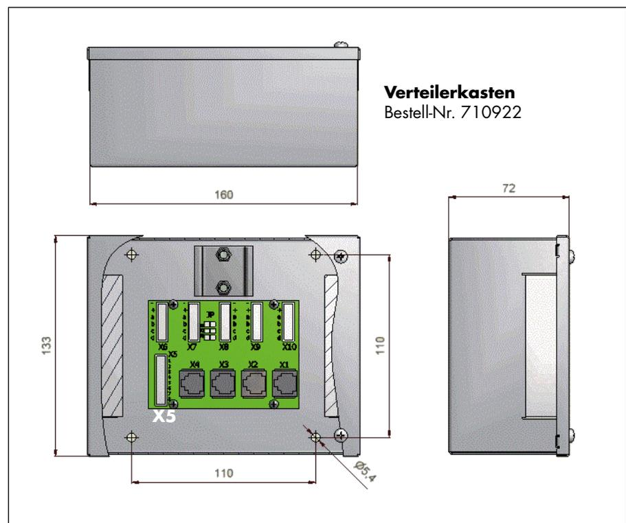
Eine Zugentlastung für die ein- und ausgehenden Kabel wird über Befestigung der Kabel mit Hilfe von Kabelbindern an den beiden Kabelauflegewinkeln erreicht. Die Kabeleinführungen werden staubsicher durch Schaumstoff abgedichtet.
