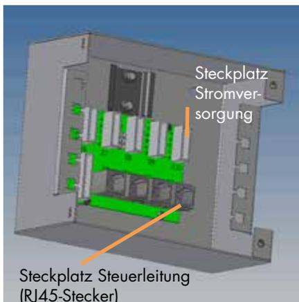
Im Verteilerkasten sind jeweils 4 Steckplätze für die Steuer- sowie Stromversorgungsleitungen vorhanden. Diese werden für den Anschluß der Steuerterminals und - bei Bedarf - auch für die Verbindung mehrerer Verteilerkästen verwendet.
