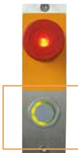
Der Piezotaster ist ideal für den Einsatz in Reinnräumen, da er keinerlei mechanisch bewegliche Teile hat. Dadurch kann sich nirgends Schmutz festsetzen und der Taster ist keinem mechanischen Verschleiß ausgesetzt. Der Taster hat mit 20 Mio. Betätigungen eine sehr lange Lebensdauer. Er ist sehr resistent gegen Umgebungseinflüsse. Zur Betätigung ist nur ein ganz leichter Druck erforderlich.
