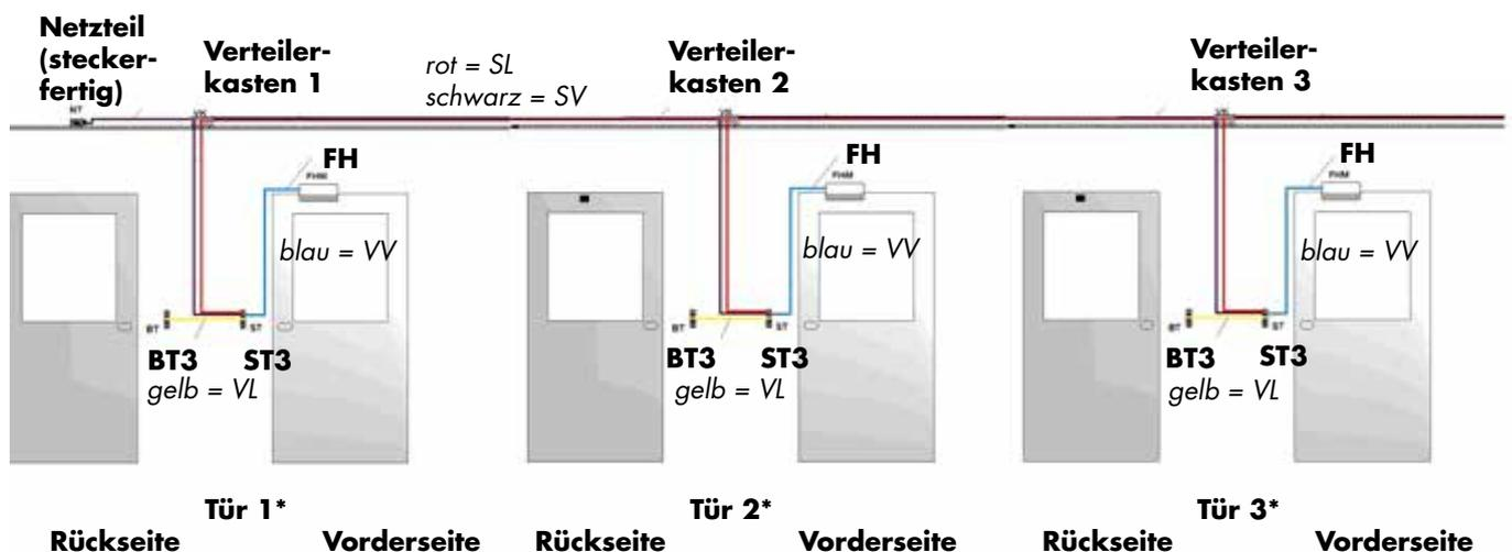
\*: Pro Verteilerkasten können zwischen 1 und maximal 4 Türen angeschlossen werden (4 Türen nur dann, wenn insgesamt nur 1 Verteilerkasten im Einsatz ist, siehe Seite 08.015.00)
