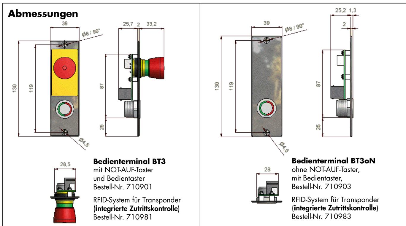
Das Bedienterminal wird einfach mit dem Verbindungskabel mit RJ45-Stecker (Farbkennzeichnung gelb) am Steuerterminal angeschlossen. Das Kabel muß separat bestellt werden. Es ist standardmäßig in zwei Längen lieferbar: 500 mm (Bestell-Nr. 710926) und 1000 mm (Bestell-Nr. 710937).
