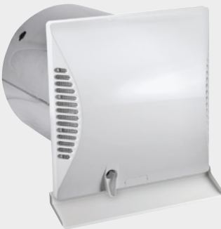
DL 50 R – Rund. Wandstärken 320 bis 530 mm. Nachträglicher Einbau mittels Kernbohrung Ø 302 / 320 mm.
