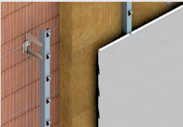
Hinterlüftete Fassade – waagrecht auf Mauerwerk
