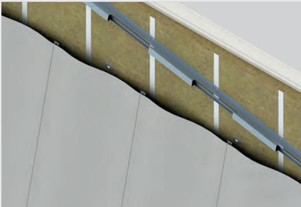
Hinterlüftete Fassade – schräg auf Kassetten-
