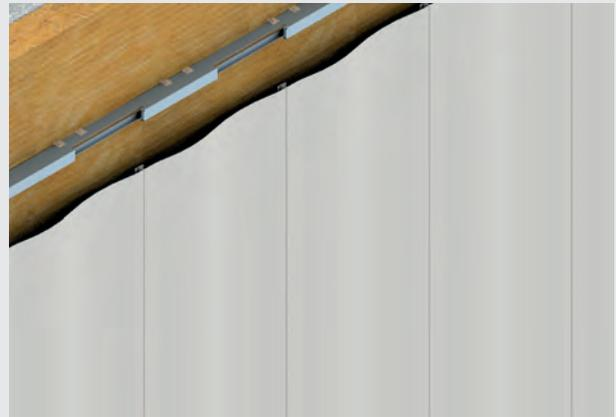
Hinterlüftete Fassade – senkrecht auf Betonwand
