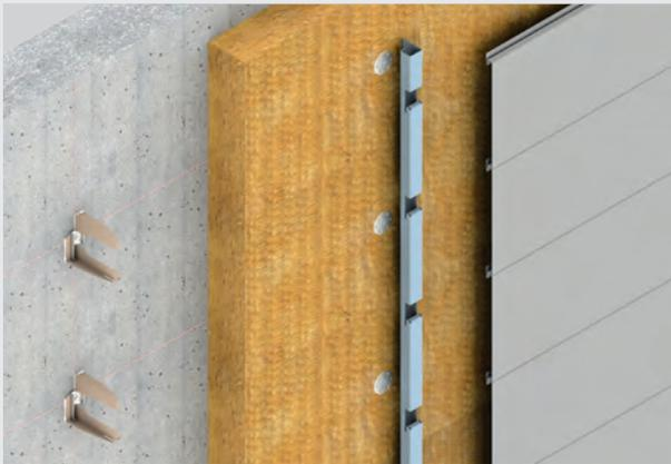
Hinterlüftete Fassade – waagrecht auf Betonwand
