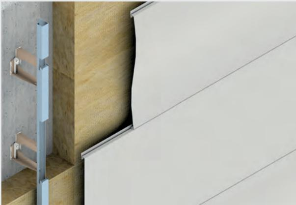
Hinterlüftete Fassade – waagrecht auf Betonwand
