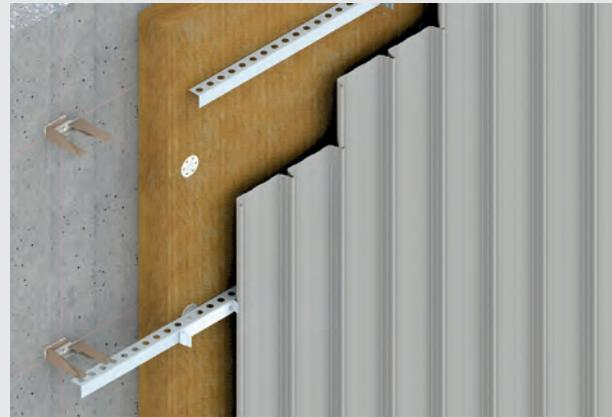
Hinterlüftete Fassade – senkrecht mit Gleitbügel
