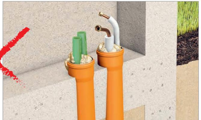
Zur Einführung der Rohre und Kabel werden häufig KG-Rohre zweckentfremdet eingesetzt. Die Abdichtung zum Bauwerk und zur Leitung ist nicht oder nicht dauerhaft gegeben und entspricht somit nicht dem Stand der Technik und den gesetzlichen Vorgaben!
