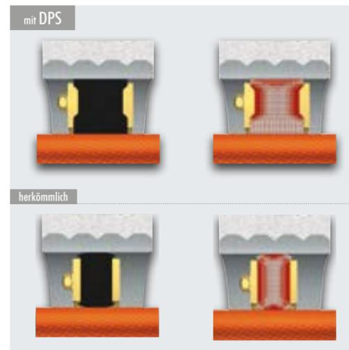
DOYMA DPS verteilt den Druck intelligenter: Im Vergleich zu herkömmlichen Dichtungseinsätzen erhöht sich der Anpressdruck in Richtung Kernbohrung (bzw. Futterrohr). Gleichzeitig reduziert sich der Anpressdruck auf die Medienleitung um bis zu 30 %.
