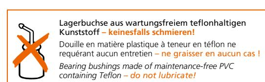
Lagerbuchse aus wartungsfreiem teflonhaltigen Kunststoff – **keinesfalls schmieren!**
