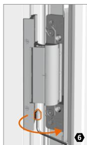
Untere Verstellspindel bei allen Bändern demontieren.
