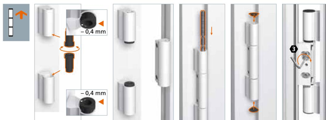
Dichtungsdruck verstellen · Réglage de la pression du joint · Adjusting the sealing pressure
