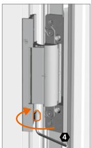
Untere Verstellspindel bei allen Bändern ein-drehen.
