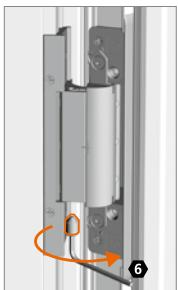
Untere Verstellspindel bei allen Bändern demontieren.
