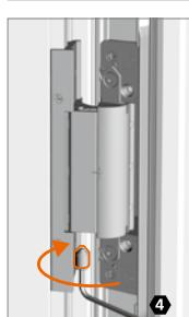
Untere Verstellspindel bei allen Bändern ein-drehen.
