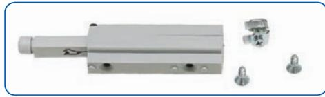
Der Push & Pull arbeitet mit einer Druckfeder und wird in das hintere Ende der Laufschiene montiert. So lassen sich Schiebetüren, die bündig in die Wand einfahren, mit einem kleinen Schubs auf das Türblatt komfortabel aus der Box holen. Ein Stirnziehgriff wird nicht mehr benötigt.
