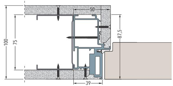
Trockenbauwand, Profil 50, zweimal belegt (GKB 12.5)
