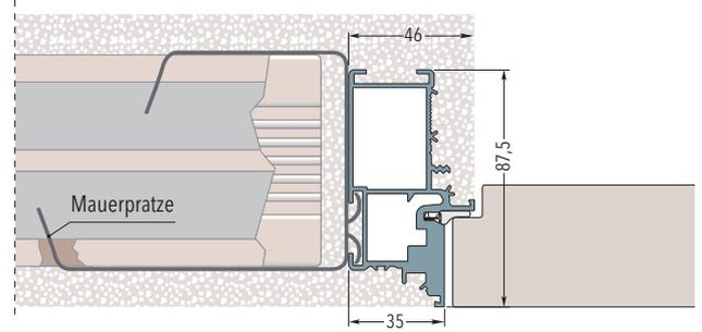
Trockenbauwand, Profil 75, einmal belegt (GKB 12.5)mm
