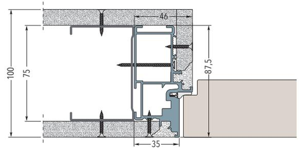
Trockenbauwand, Profil 50, zweimal belegt (GKB 12.5)
