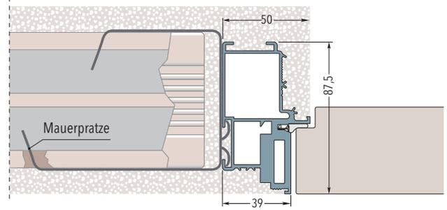
Trockenbauwand, Profil 75, einmal belegt (GKB 12.5)mm
