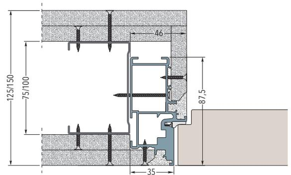
Die Zarge kann sowohl in eine Trockenbau- als auch in eine Massivwand eingesetzt werden. Die für die Massivwand erforderlichen Metallpratzen sind im Lieferumfang enthalten.
