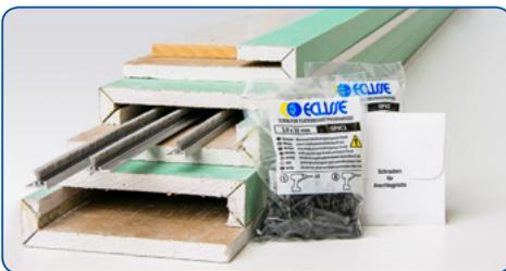
Die Planbox aus Gipskarton-Formteilen bietet eine einfache Möglichkeit um UNICO für Trockenbau optisch wandbündig zu verkleiden. Lieferbar für 1- und 2-flg. ECLISSE UNICO-Modelle, für die fertigen Wandstärken 12,5 | 15 | 17,5 cm. Die passgenauen Formteile sind in Feuchtraumqualität GKBI 12,5 mm ausgeführt, inkl. Staubbürsten in Alu-Profilen, GK-Schrauben für zweite Belegung (3,9 x 32) und weißer Anschlagplatte aus Holzwerkstoff geeignet zur Montage von Schließblechen.
