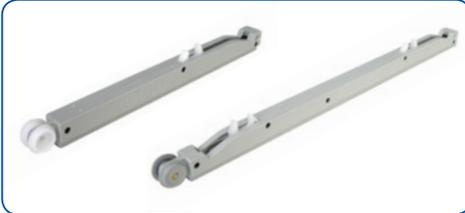
Die Einzugsdämpfer ECLISSE BIAS® und ECLISSE BIAS® DS werden vorteilhaft in der Laufschiene geführt und können jederzeit, auch bei eingebautem Türblatt, justiert werden. ECLISSE BIAS® bremst und zieht Türblätter bis 40 kg in der Schließbewegung an das Anschlagprofil. ECLISSE BIAS® DS hat zusätzlich noch eine Bremsfunktion auf den letzten Zentimetern bei der Öffnungsbewegung des Türblattes.
